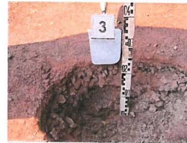
Abbildung 2: Schürfgrube SG 3 - Schichtenprofil
