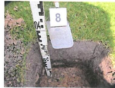
Abbildung 3: Schürfgrube SG 8 - Schichtenprofil
