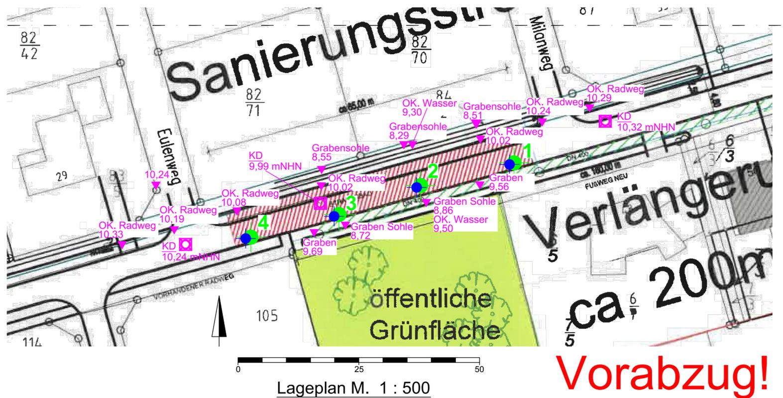
Die Lage und Höhe der Ansatz- und Geländepunkte wurden mit dem satellitengestützten Positionssystem Topcon via GNSS-Technik (GPS/GLONASS) eingemessen (Genauigkeit ca. Horiz. = 1 bis 2 cm, Vert. = 1,5 bis 3 cm).
